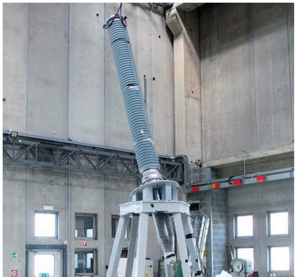
Izolyator HV bushing on a test rack at CESI S. p. A.
