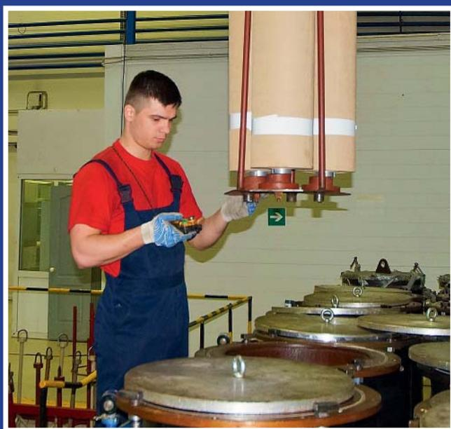
Загрузка остовов вводов в камеры термовакuumной сушки
