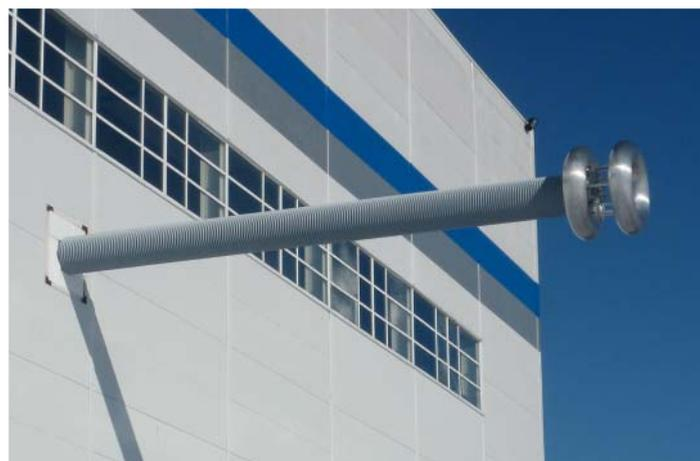
Испытания линейного ввода 820 кВ постоянного тока.
