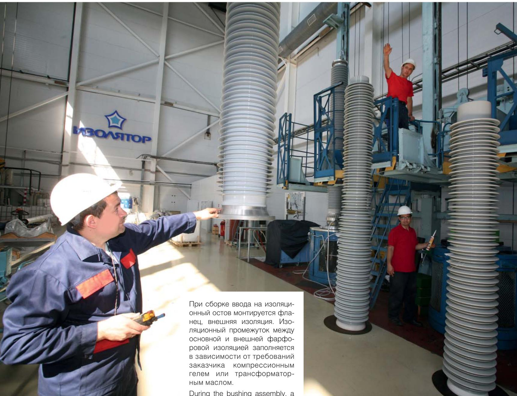
При сборке ввода на изоляционный остов монтируется фланец, внешняя изоляция. Изоляционный промежуток между основной и внешней фарфоровой изоляцией заполняется в зависимости от требований заказчика компрессионным гелем или трансформаторным маслом.
