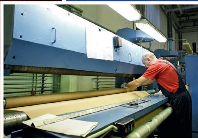
Намотка изоляции 110 кВ широким полотном
