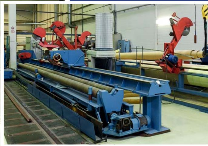
Намоточное оборудование изоляции до 750 кВ
