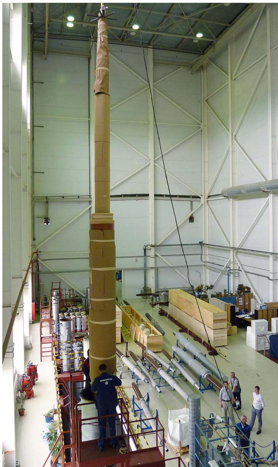
Выгрузка остова 1150 кВ из камеры термовакuumной сушки
