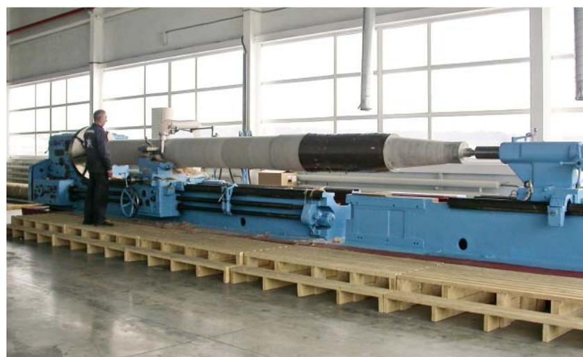
Механическая обработка RIP-изоляции ввода 820 кВ постоянного тока
