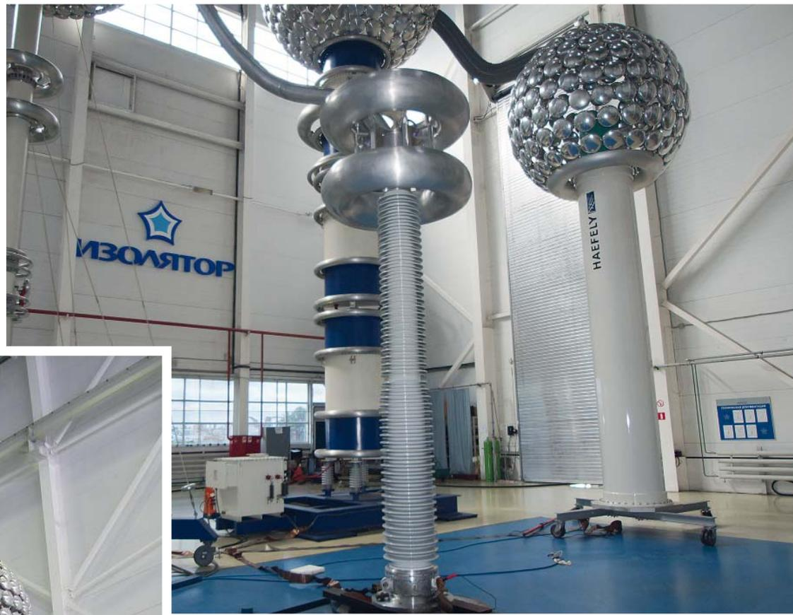
Испытания ввода 750 кВ с применением
