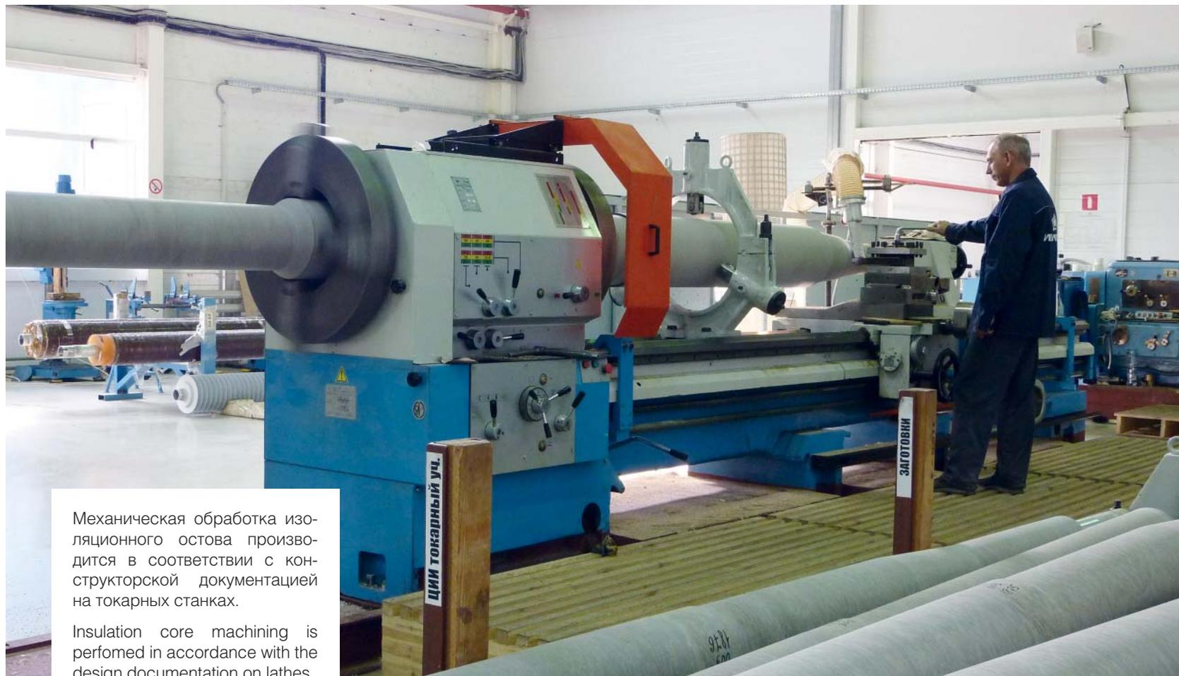
Механическая обработка изоляционного остова производится в соответствии с конструкторской документацией на токарных станках.
