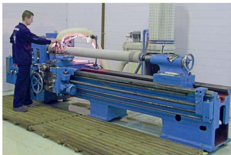
Токарная обработка RIP-изоляции 110 кВ
