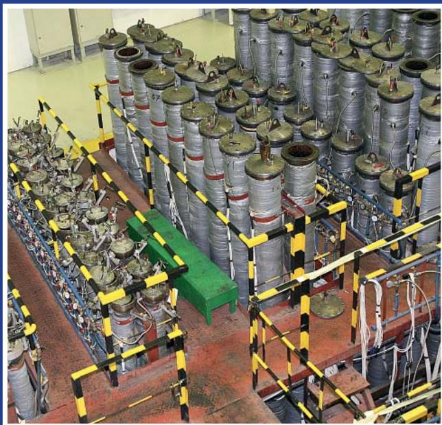
Камеры пропитки и полимеризации RIP-изоляции до 220 кВ
