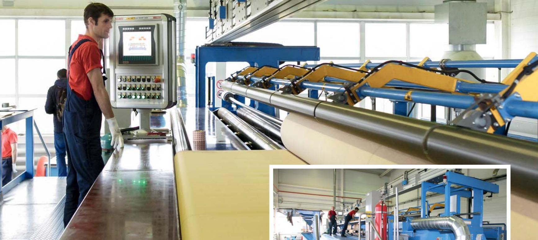
▲ Высокопроизводительный станок для намотки основной изоляции вводов на классы напряжения 220–1150 кВ
