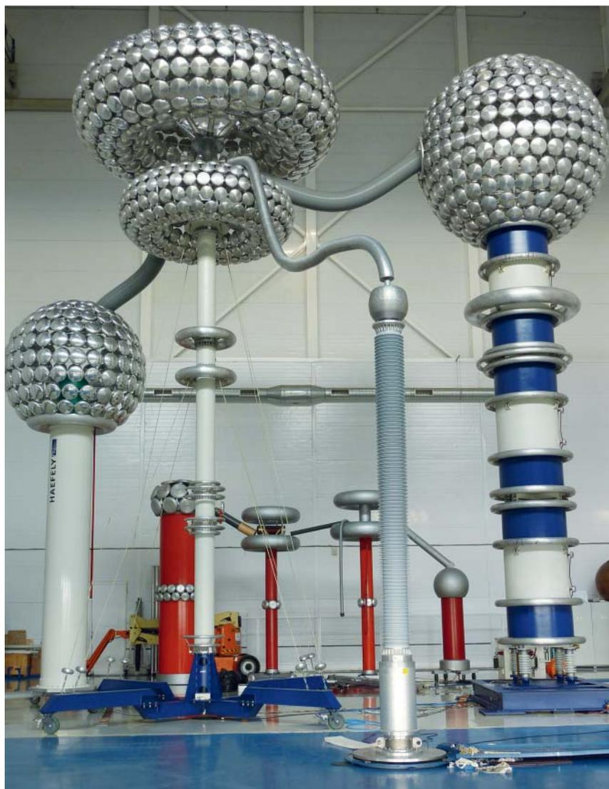
Испытания ввода 280 кВ постоянного тока в системе
